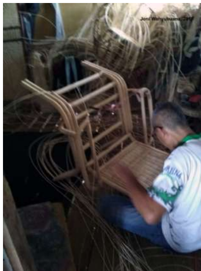
Gambar 25. Proses Penganyaman Bidang Sandaran. Sumber foto: Dokumentasi penelitian.
