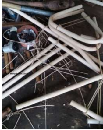
Gambar 19. Proses pemotongan setelah pelengkungan. Sumber foto: Dokumentasi Penelitian.
