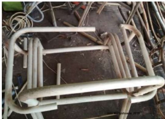
Gambar 23. Pemasangan Sandaran Tangan. Sumber foto: Dokumentasi Penelitian.
