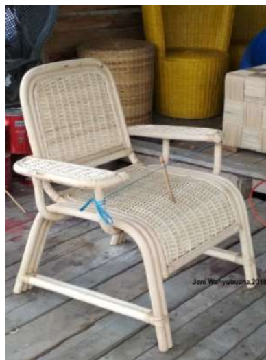
Gambar 27. Kursi rotan setelah proses penganyaman dan siap diberikan cat pelapis berbasis air. Sumber foto: Dokumentasi Penelitian.
