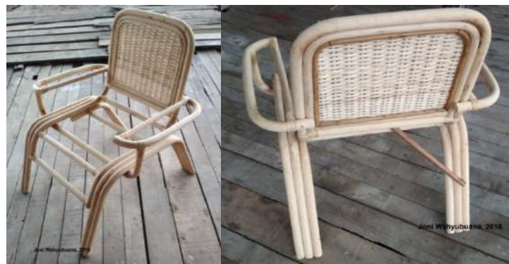
Gambar 26. Rangka dan Bidang Sandaran yang telah dianyam. Sumber foto: Dokumentasi Penelitian.
