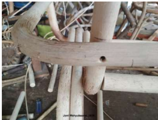
Gambar 24. Sambungan dan penguatan rangka rotan menggunakan sekrup. Sumber foto: Dokumentasi Penelitian.
