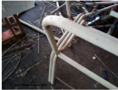
Gambar 20. Bentuk Lengkung Pada Rangka Sandaran. Sumber foto: Dokumentasi Penelitian.
