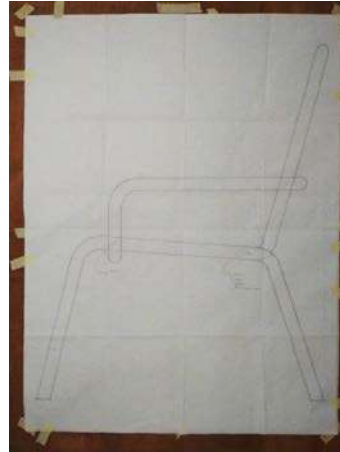
Gambar 15. Gambar Tampak samping kursi rotan skala 1:1. Sumber foto: Dokumentasi penelitian.
