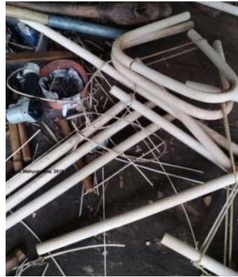
Gambar 19. Proses pemotongan setelah pelengkungan. Sumber foto: Dokumentasi Penelitian.
