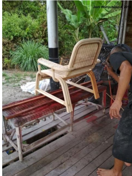
Gambar 29. Proses pelapisan cat dasar pada kursi rotan. Sumber foto: Dokumentasi Penelitian.
