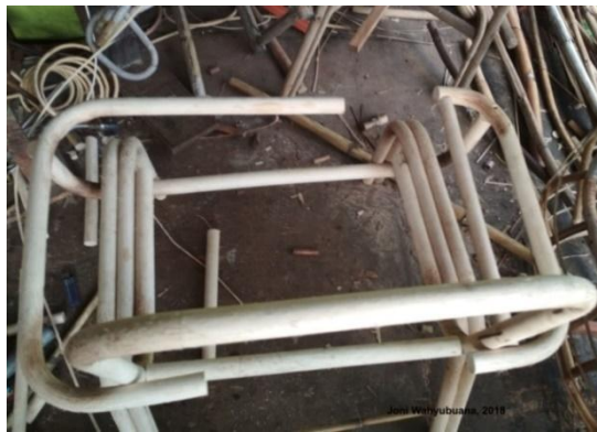
Gambar 23. Pemasangan Sandaran Tangan. Sumber foto: Dokumentasi Penelitian.
