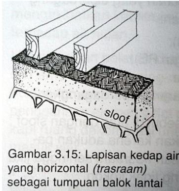
Gambar 3.15: Lapisan kedap air yang horizontal (*trasraam*) sebagai tumpuan balok lantai
